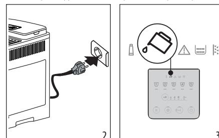
2. На контролния панел (B) се включва индикаторът (B10) (фиг. 3): измъкнете резервоара за вода (A9) (фиг. 4), напълнете го до MAX ниво с прясна вода (фиг. 5), поставете отново резервоара.
